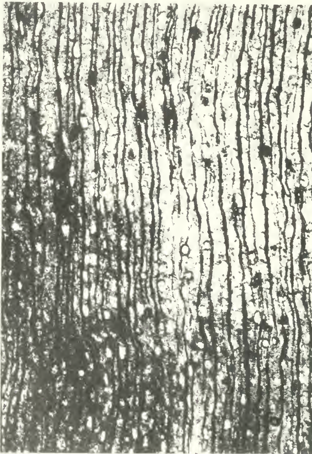
Abb. 2: Querschliff. Zahlreiche, kleine Gefäße und dunkle Holzstrahlen. 1984 I 205; x 45
